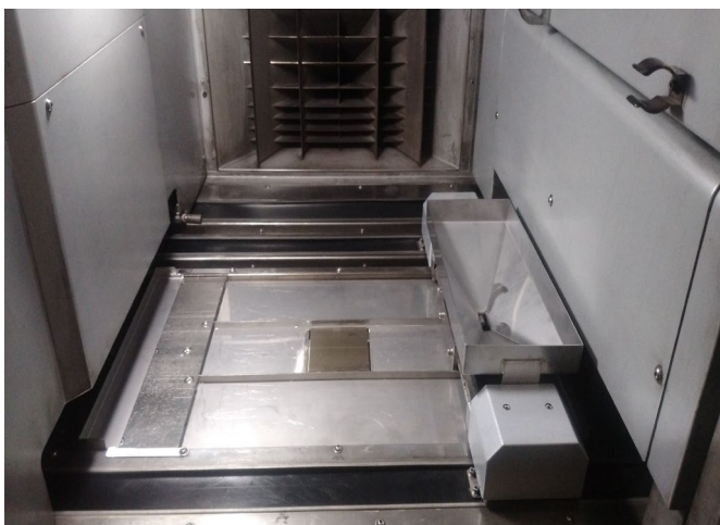
金属 3D プリンタ用 試験造形対応ユニット 「Material Trial Unit」
